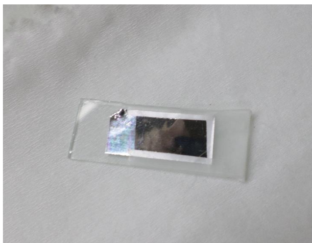
Figura 4.2. Iones de Ni depositados exitosamente en una membrana de alúmina hasta su superficie. El área afectada toma un color más oscuro.
