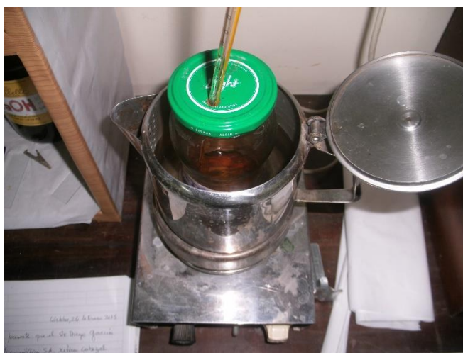
Figura 3.5. Sistema de decapado. El frasco con solución abrasiva se encuentra debajo de la pava, la cual está llena con agua y apoyada en una fuente de calor. También se dispone de un termómetro para controlar la temperatura.
