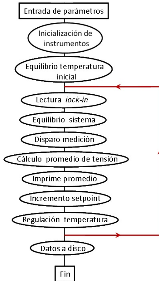
Figura A.1: Diagrama de flujo del programa utilizado para efectuar la adquisición de datos en la etapa experimental microscópica.
